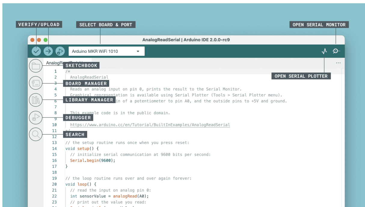
Abbildung 2: Ausschnitt der Benutzeroberfläche (GUI) der Arduino IDE auf einem Mac mit verschiedenen Beschreibungen (Söderby & Hysten, 2024)
